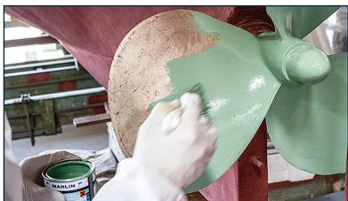
Aplicación de la imprimación metálica.
